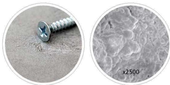
NICHT VERDICHETER BETON
